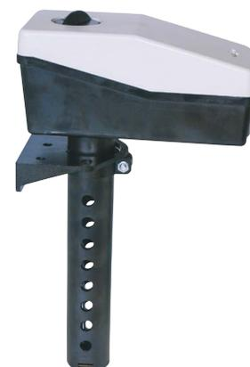
(\*) La precisione dell'umidostato si riferisce al punto di calibrazione di fabbrica a 55% RH alla temperatura di 23 °C. La precisione varia come indicato nel grafico seguente. In generale i sensori di umidità sono soggetti ad invecchiamento se vengono installati o immagazzinati in presenza di gas molto aggressivi. In queste condizioni l'umidostato si stacca prematuramente e perde la sua linearità.
