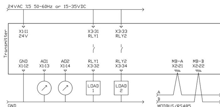
La portata dei contatti del relè è max. 1A a 230 VAC. Si consiglia di utilizzare 24 VAC per evitare armoniche ad alta tensione e l'utilizzo di un relè di potenza esterno per carichi maggiori. Utilizzare cavi schermati e doppiati intrecciati per le connessioni modbus.
